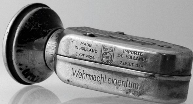
latarka firmy Philips, wyposażona we własne dynamo, produkowana specjalnie na potrzeby Wehrmachtu (nr inw. MSt-I-9-34)
